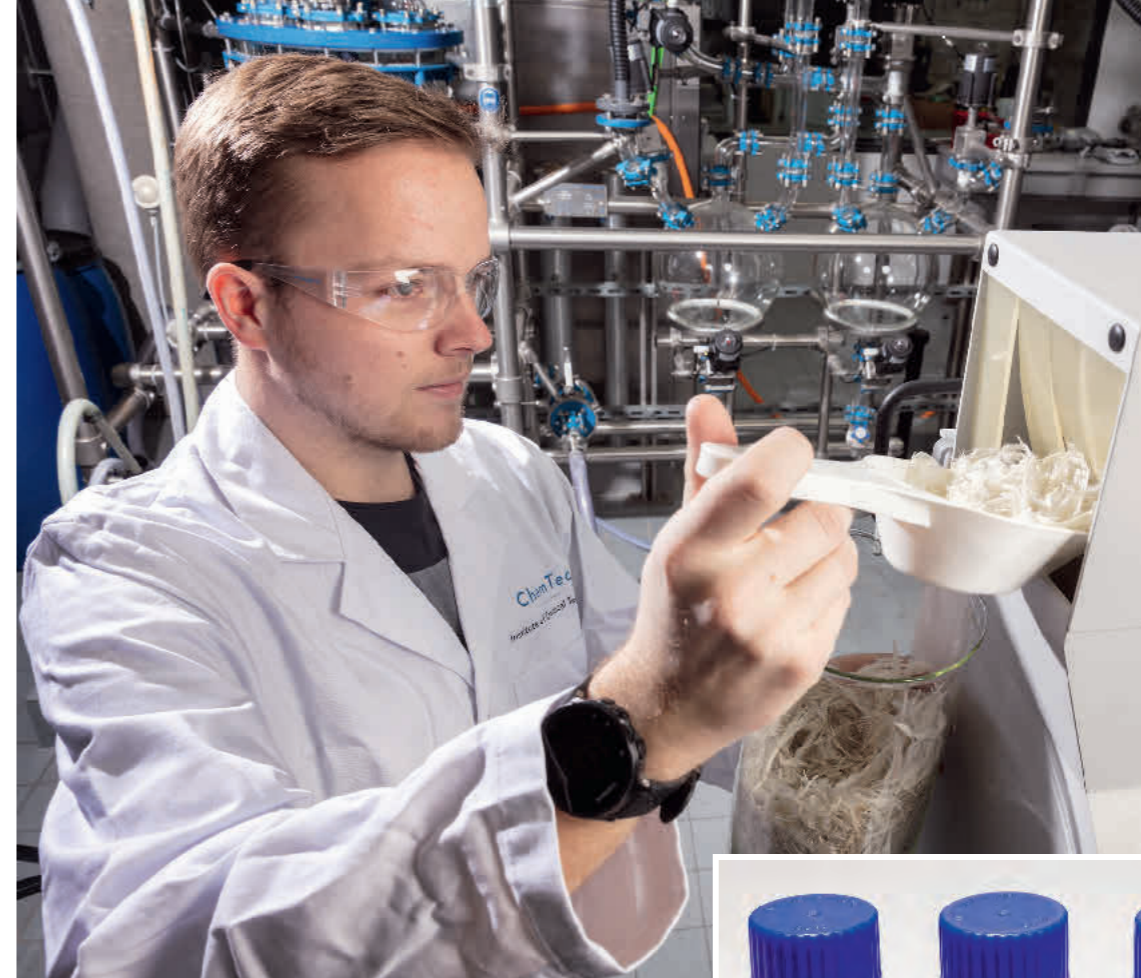
Masterstudent Loïc Habegger füllt Hühnerfedern ins Mahlwerk, um ihr Fett mit einem Enzym zu entfernen. Dann wird das Keratin abgetrennt, aus der Lösung gefiltert und zu Pulver verarbeitet. Unten: In kleine Fläschchen gefüllt sind Zwischenprodukte der Produktionskette von unverarbeiteten Vogelfedern über gemahlene und aufgelöste Federn bis zum reinen Keratin.
